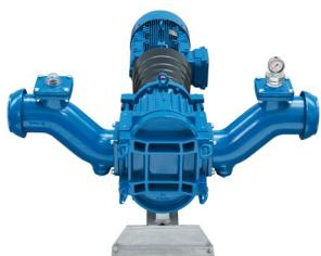
**AT iegremdējamais motora sūknis** – iegremdējams sūknis ar IP68 aizsardzības klasi, kas ir piemērots lietošanai vircas krātuvēs ar dziļumu 9 - 25 m. Šajā vienkārši uzstādāmajā sūknī ir iebūvēts automātslēdzis, kas nepielauj caurules aizsērēšanu. Sūknēšanas ātrums: 2500 - 6700 litri minūtē
